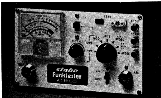
Afb. 143: Voorbeeld van een universeelmeetapparaat voor de CB-amateur, met behulp waarvan zendvermogen, staandegolfverhouding (VSWR), toestand van het kristal (goed/slecht) enz. gemeten kunnen worden
